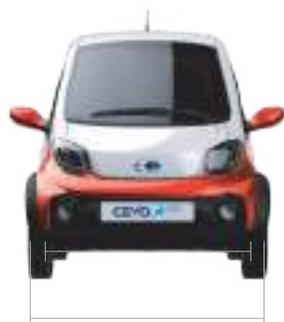
Banda de rodadura (delantera) 1.250
